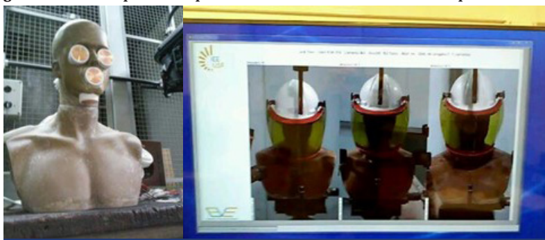
Figura 28. Ensaios piloto em protetores faciais utilizando o manequim de cabeça
