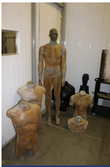
Figura 11. Manequins de Torso/Pernas desenvolvidos no Brasil para avaliações de desempenho contra os efeitos térmicos de arcos elétricos
