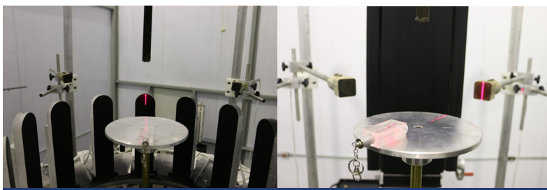
Figura 23. Alinhamento do sistema utilizando sistema óptico e guia graduado
