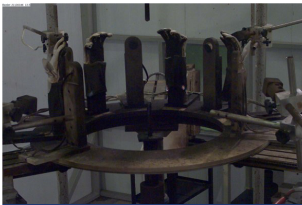
Figura 27. Ensaios piloto em luvas de proteção térmica
