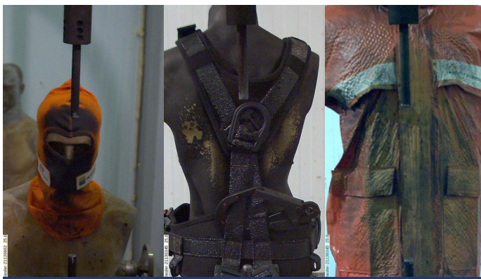
Figura 29. Ensaios piloto em balaclavas, cinturão paraquedista e impermeáveis
