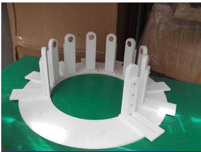
Figura 8. Dispositivo para ensaios de luvas de proteção contra efeitos térmicos de arcos elétricos
