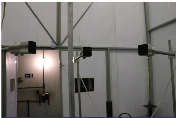
Figura 14. Sensores calorímetros externos montados em suportes junto a gaiola de ensaios
