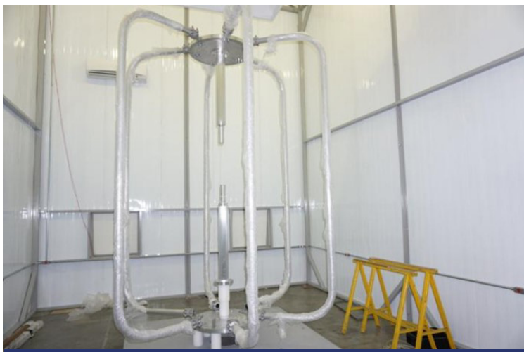
Figura 6. Montagem inicial da gaiola de ensaios no container instalado no SVALPOT/IEE-USP
