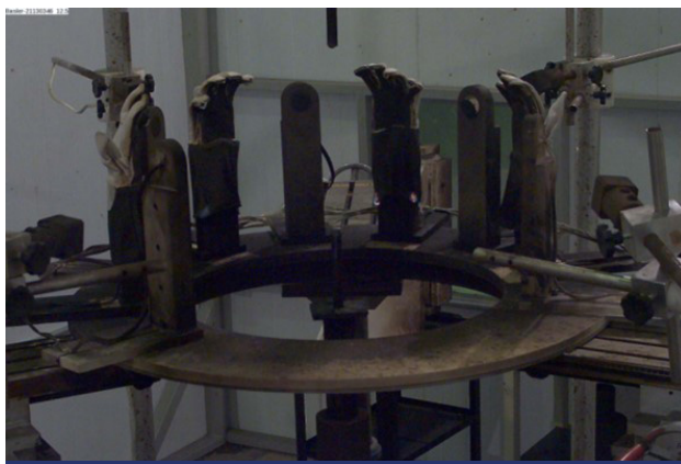
Figura 27. Ensaios piloto em luvas de proteção térmica
