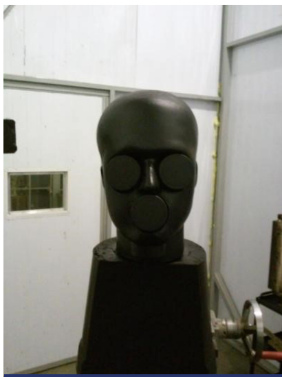
Figura 10. Primeiro manequim de cabeça com sensores para avaliações em protetores dos olhos, da face e cabeça
