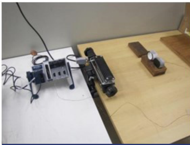
Figura 2. Primeiros testes com sistema de aquisição de sinais de elevação de temperatura por calor irradiado, simulada por meio de lâmpadas de alta intensidade
