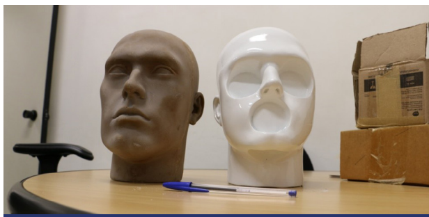
Figura 19. Primeiros protótipos de manequim de cabeça para validação dimensional e térmica
