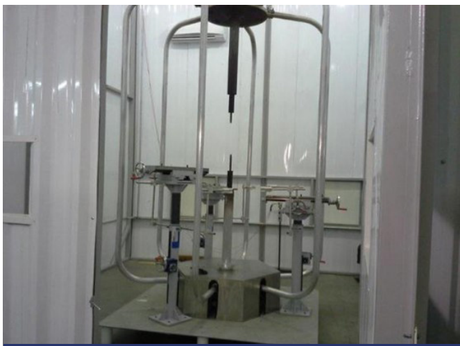
Figura 7. Gaiola com as mesas de três eixos para suporte de materiais e corpos de prova
